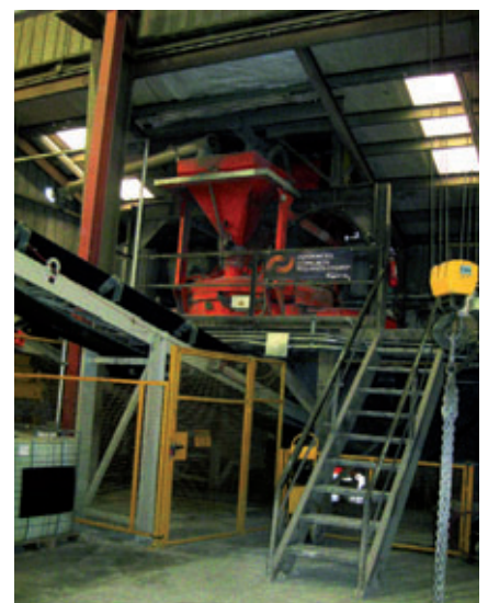
Смеситель ACT (Advanced Concrete Technology) вместимостью 1,7 м 3
